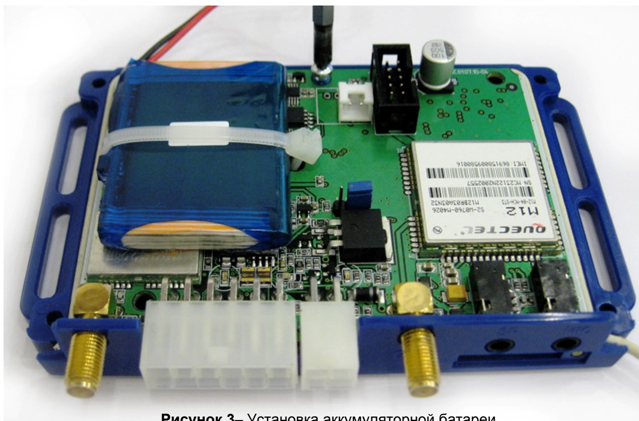
Рисунок 3– Установка аккумуляторной батареи
